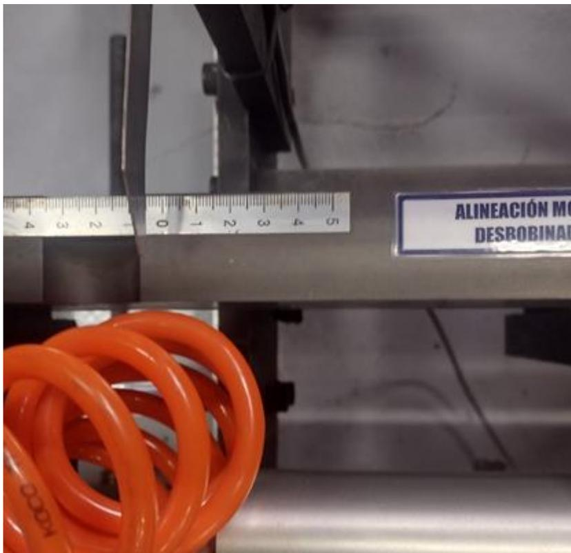
**ILUSTRACIÓN 4 CINTA MÉTRICA PARA ALINEAR EL MÓDULO DESBOBINADOR**
