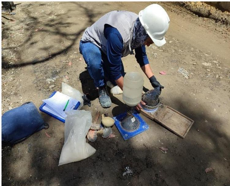
**Ilustración 23.** Prueba de densidad en la abscisa K0+265 en el tramo 01 La Magdalena. Fuente: informes de Consicor S.A.S.
