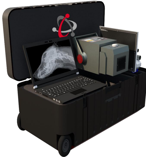
Fig. 5. Prototipo de la maleta con los diferentes elementos del equipo de RX portátil (Renderizado)
