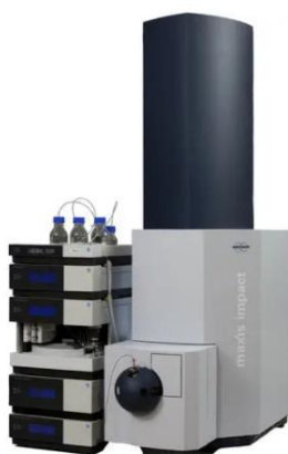
Figura 13. Cromatografía líquida de alta eficiencia (HPLC) Dionex acoplado a un espectrómetro de masas de tiempo de vuelo cuadrupolo (Q/TOF). (Fuente: Direct Industry,USA).
