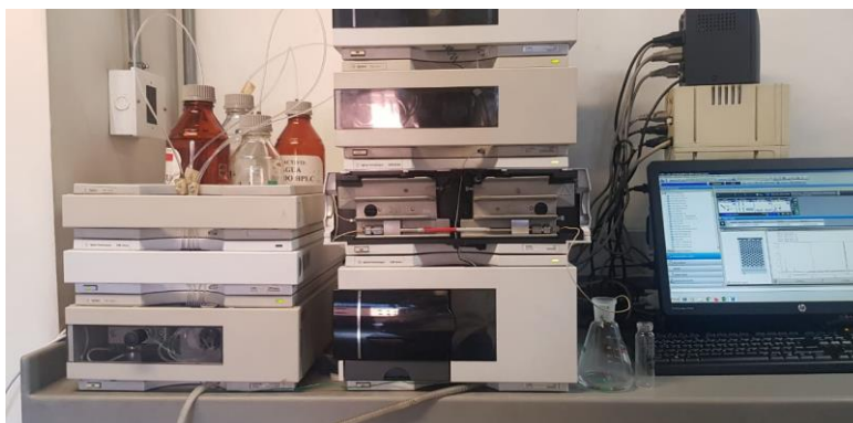
Figura 11. HPLC acoplado para la purificación del subproducto de CBZ.
