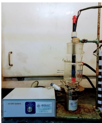
Figura 4. Equipo de ultrasonido Meinhardt acoplado a una lámpara de radiación ultravioleta (UV) de 365 nm.
