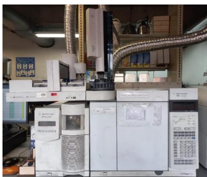
Figura 9. Sistema de cromatografía gaseosa acoplado espectrometría de masas (GC/MS) (Fuente: GDCON).
