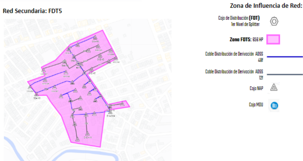
Figura 14 Esquema de red de distribución (FDT5)
