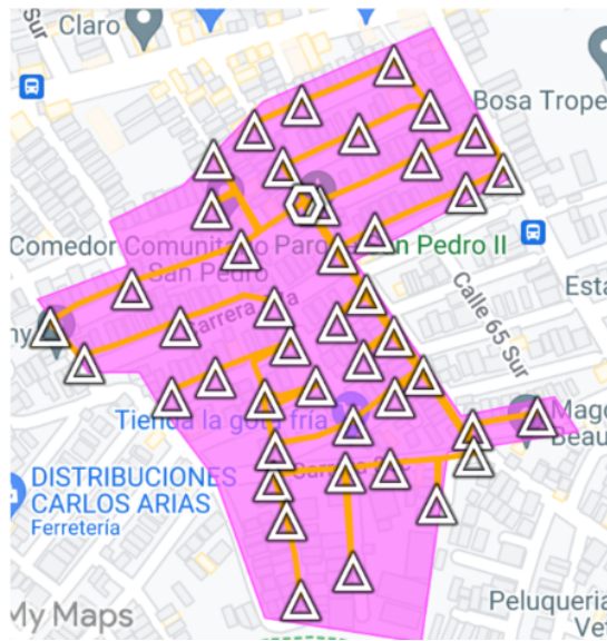
Figura 25 Esquema de red de distribución (HUB5)
