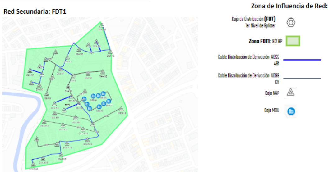
Figura 10 Esquema de red de distribución (FDT1)
