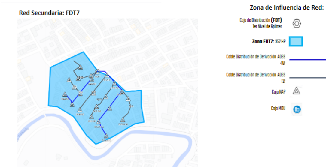
Figura 16 Esquema de red de distribución (FDT7)
