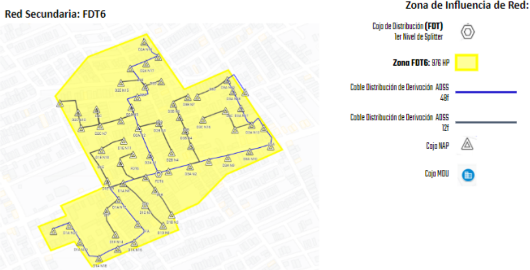
Figura 15 Esquema de red de distribución (FDT6)
