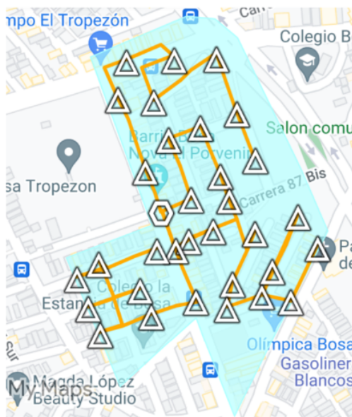
Figura 23 Esquema de red de distribución (HUB3)
