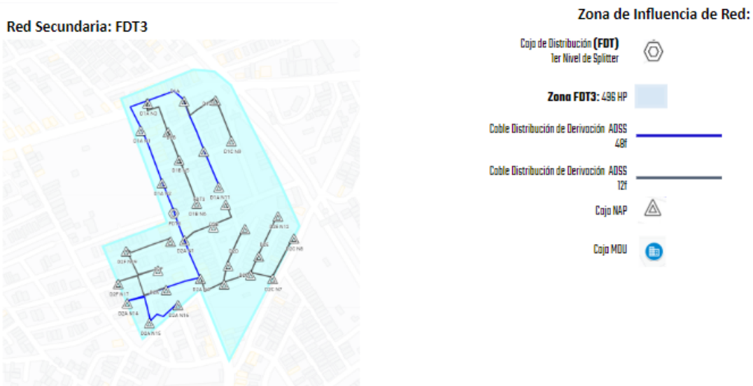
Figura 12 Esquema de red de distribución (FDT3)
