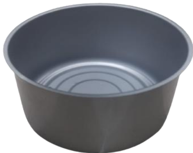
Figura 30. Producto final obtenido a partir de la copa de primera operación fabricada en el troquel homologado
