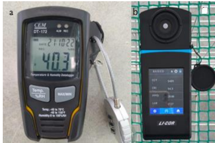
Figura 1. Instrumentos de medición de las condiciones ambientales de la cámara de crecimiento. a. Datalogger, b. Espectroradiómetro.
