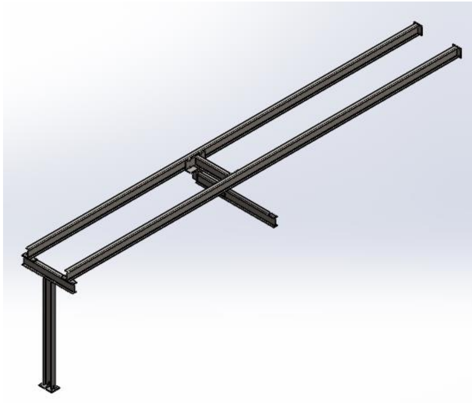
Figura 4. Puente grúa con viga en voladizo.
