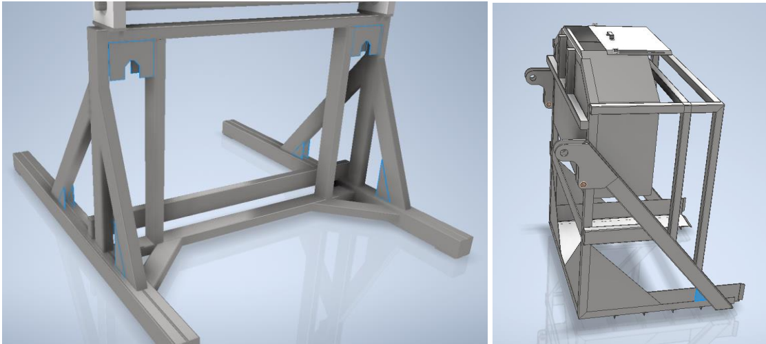
Figura 23. Láminas de refuerzo en los puntos críticos.
