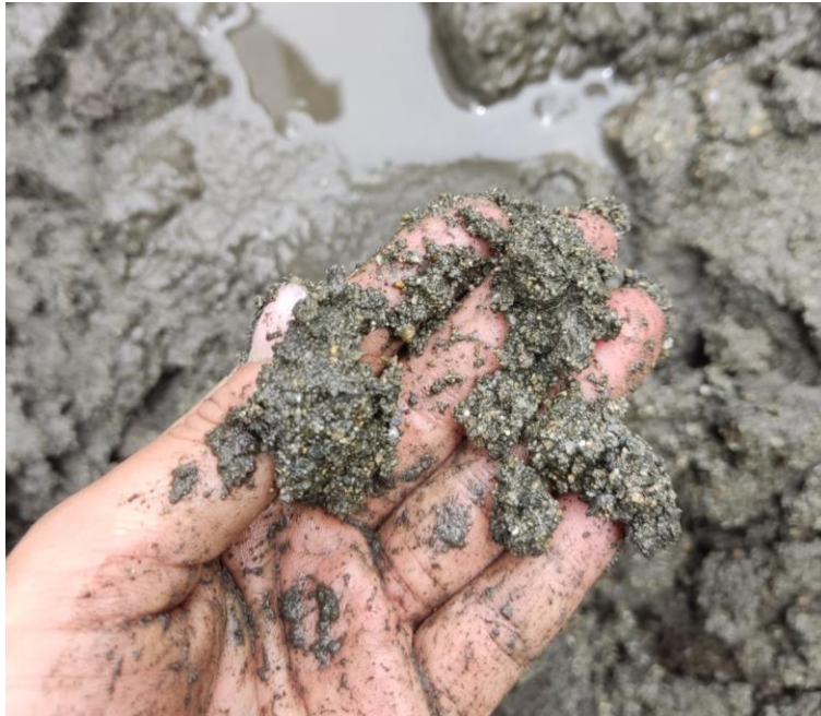
Figura 14. Lodo encontrado en clarificador.
