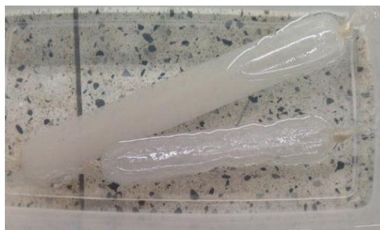
Figura 9. Montaje para diálisis de sericina en agua destilada.
