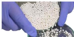
**Figura 13.** Esferas de alúmina utilizadas como cuerpos molidores en la conminución por vibración.
