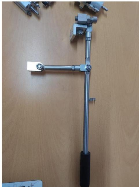
*Ilustración 14. Palanca de desplazamiento vertical, máquina de llenado*
