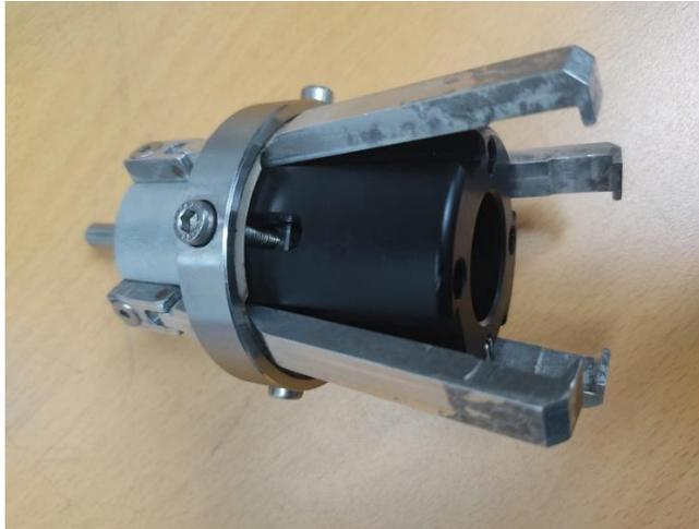
*Ilustración 15. Mandril de sujeción para tapa rosca, máquina de llenado.*
