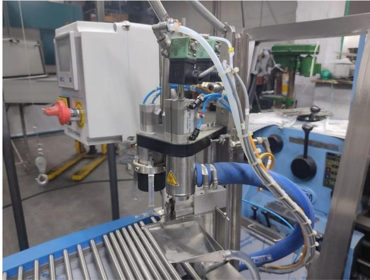
*Ilustración 13. Sistema de desplazamiento rotativo, máquina de llenado*
