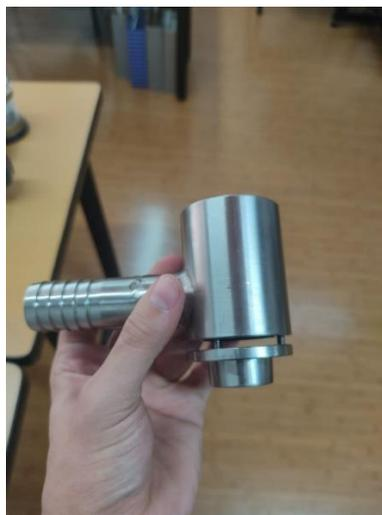
*Ilustración 12. Sistema de boquilla, máquina llenadora*
