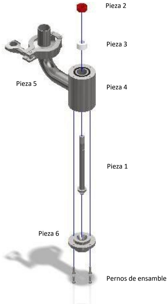
*Ilustración 38. Despiece boquilla de llenado*
