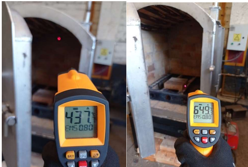
Figura 34. Diferencias en la lectura de temperatura en la zona de la solera y la cúpula. Elaboración propia.
