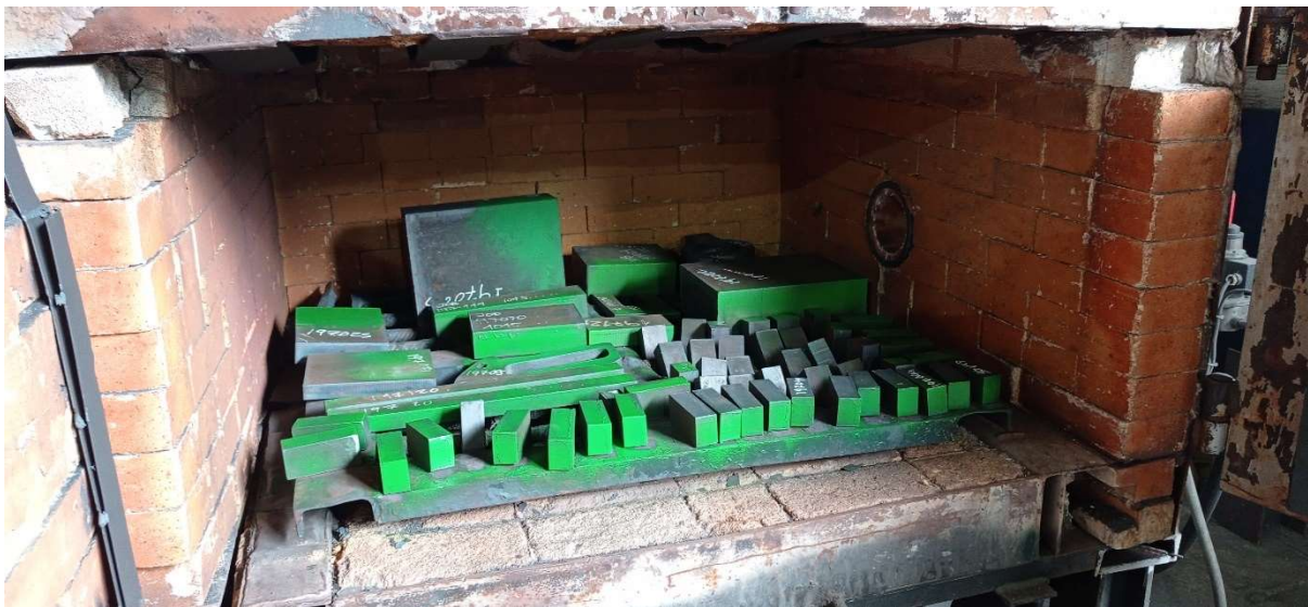
Figura 14. Ejemplo 1 de carga en horno de recocido. Elaboración propia.
