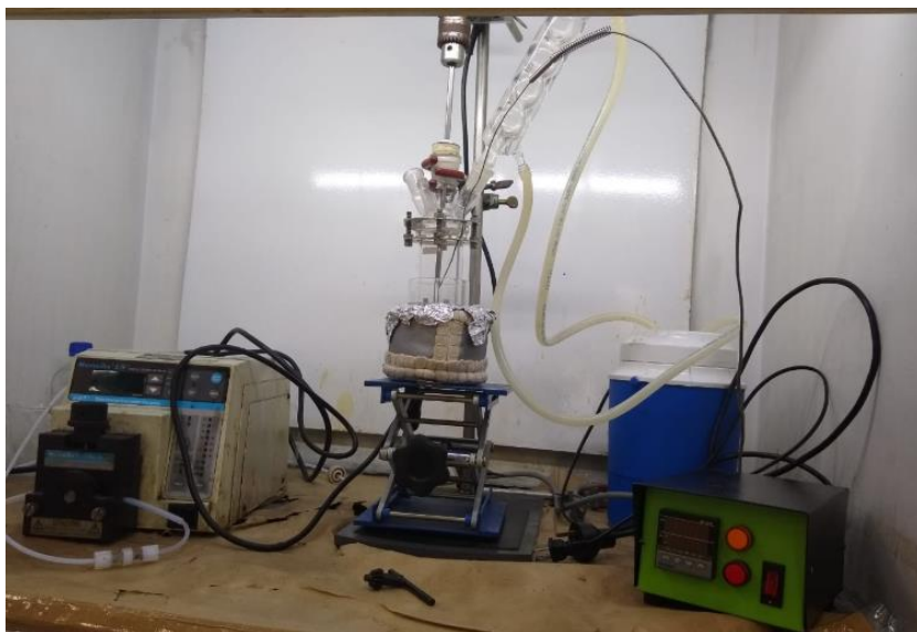
Figura 5. Montaje experimental de polimerización en emulsión
