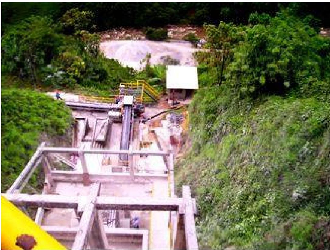
Foto 6 Sistema de transporte del material –caliza– hasta el nivel del río
