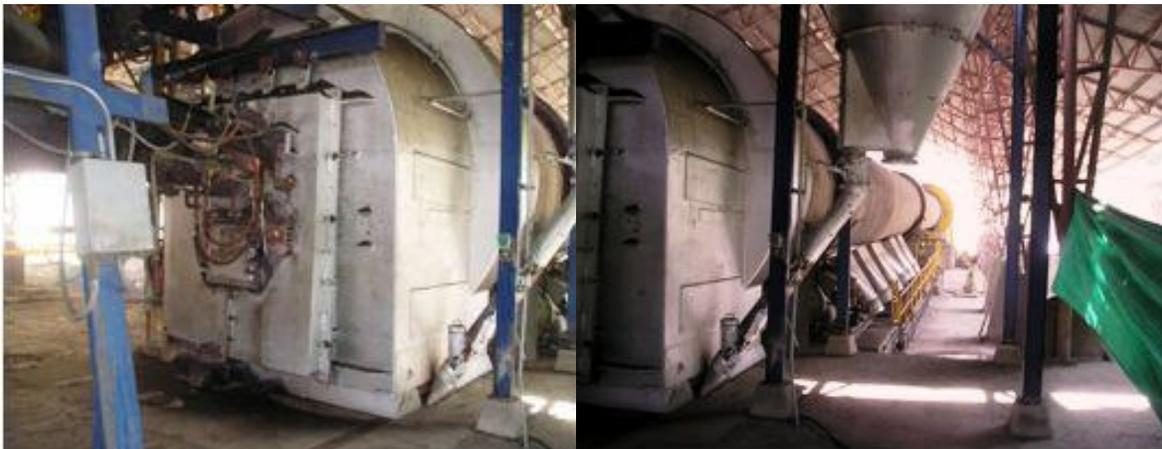
Foto 10 Horno proceso de clinklerización; estos hornos manejan altísimas temperaturas y antes eran monitoreados por un operario, en la actualidad se monitorean por sistema, aunque en ocasiones se debe ir directamente.
