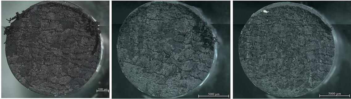
Fig. 31. Superficies de desgaste para las mezclas A) M8 – 30phr, B) M14 – 30phr, C) M30 – 30phr de EPDM-R triturado.
