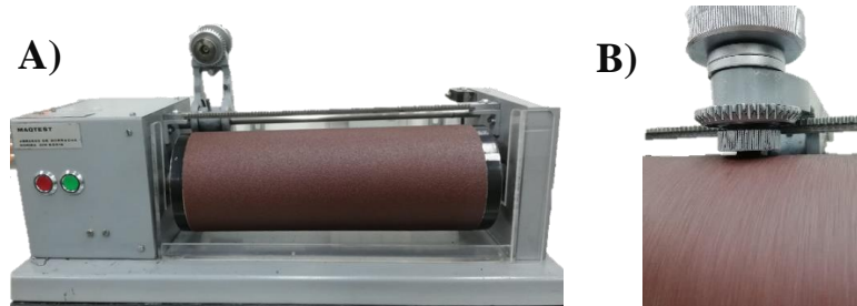
Fig. 15. Prueba de resistencia al desgaste en cauchos, bajo la norma ASTM D5963, método A. A) Abrasión de caucho MAQTEST, B) Probeta de caucho durante el ensayo.
