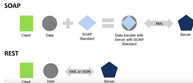
Figura 2. Estructura de una API SOAP y una API REST.
