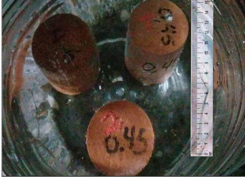
Fig. 20. Diferentes probetas sometidas al ensayo de absorción de agua.
