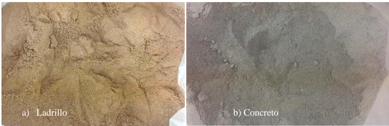
Fig. 5. Partículas de RCD pulverizado. a) RCD de ladrillo b) RCD de concreto.
