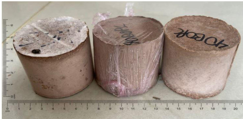
Fig. 7. Probetas AAC para ensayo de resistencia a compresión.
