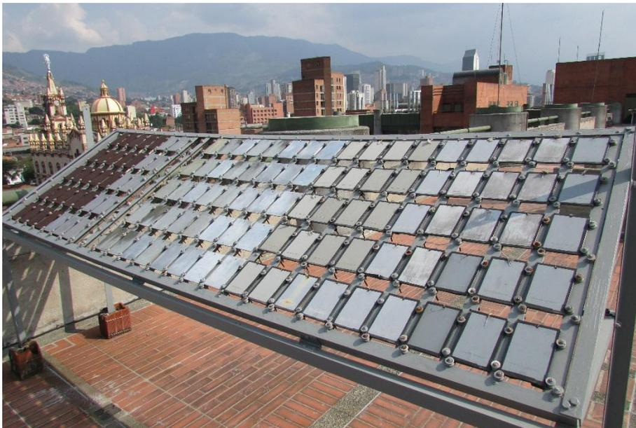
Fig. 5. Sitio de exposición de las placas metálicas de categoría C3
