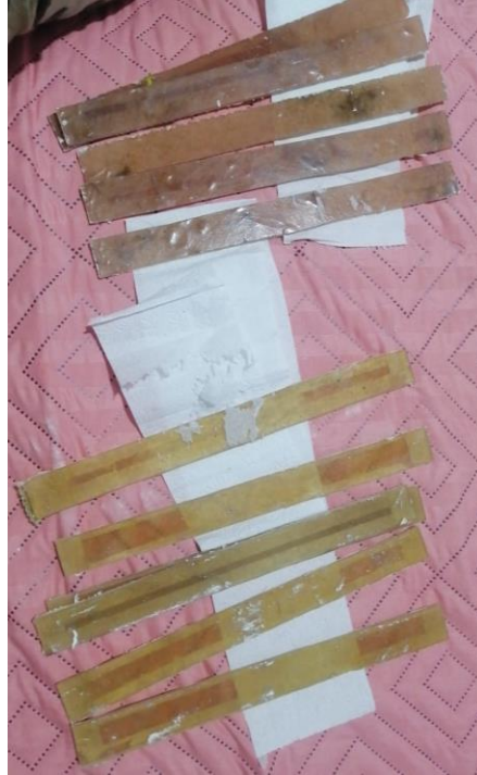
Fig. 5. Muestra de las probetas fabricadas para las pruebas de tracción.
