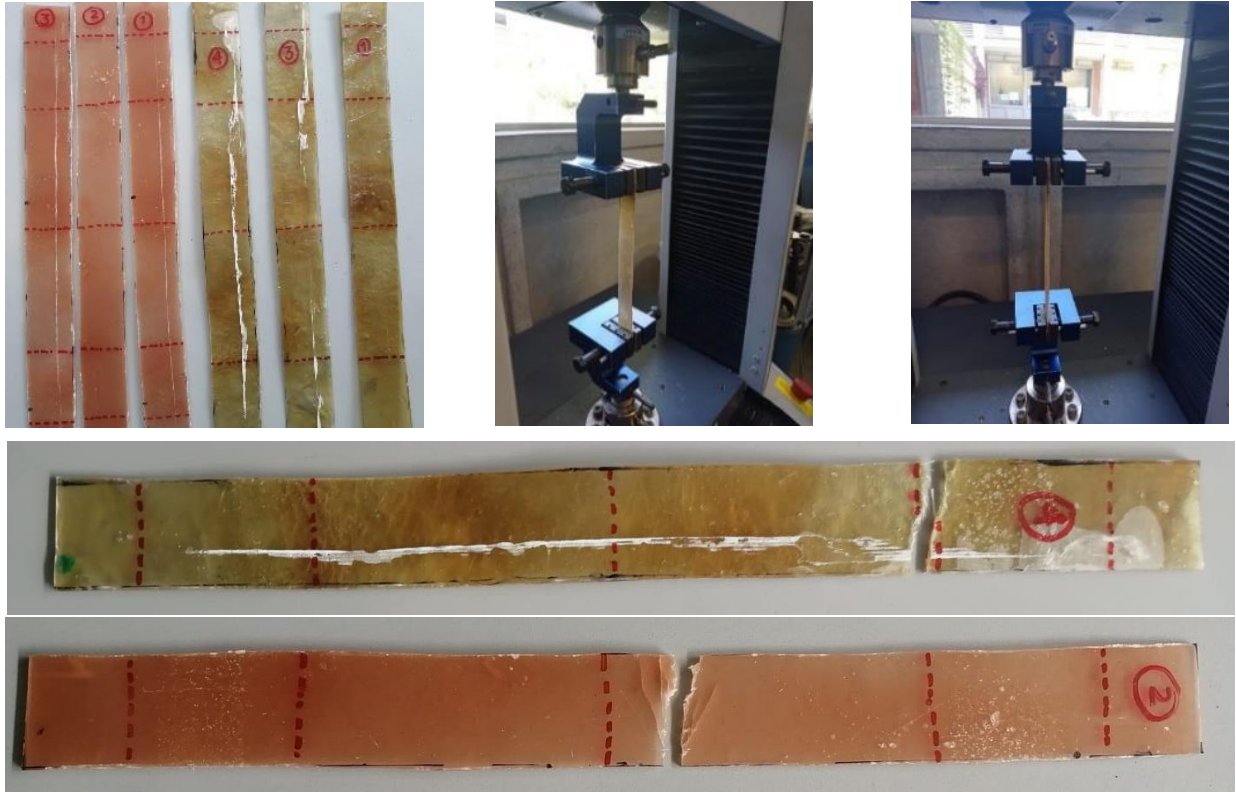
Fig. 6. Imágenes de la ejecución de la prueba de tracción realizada.
