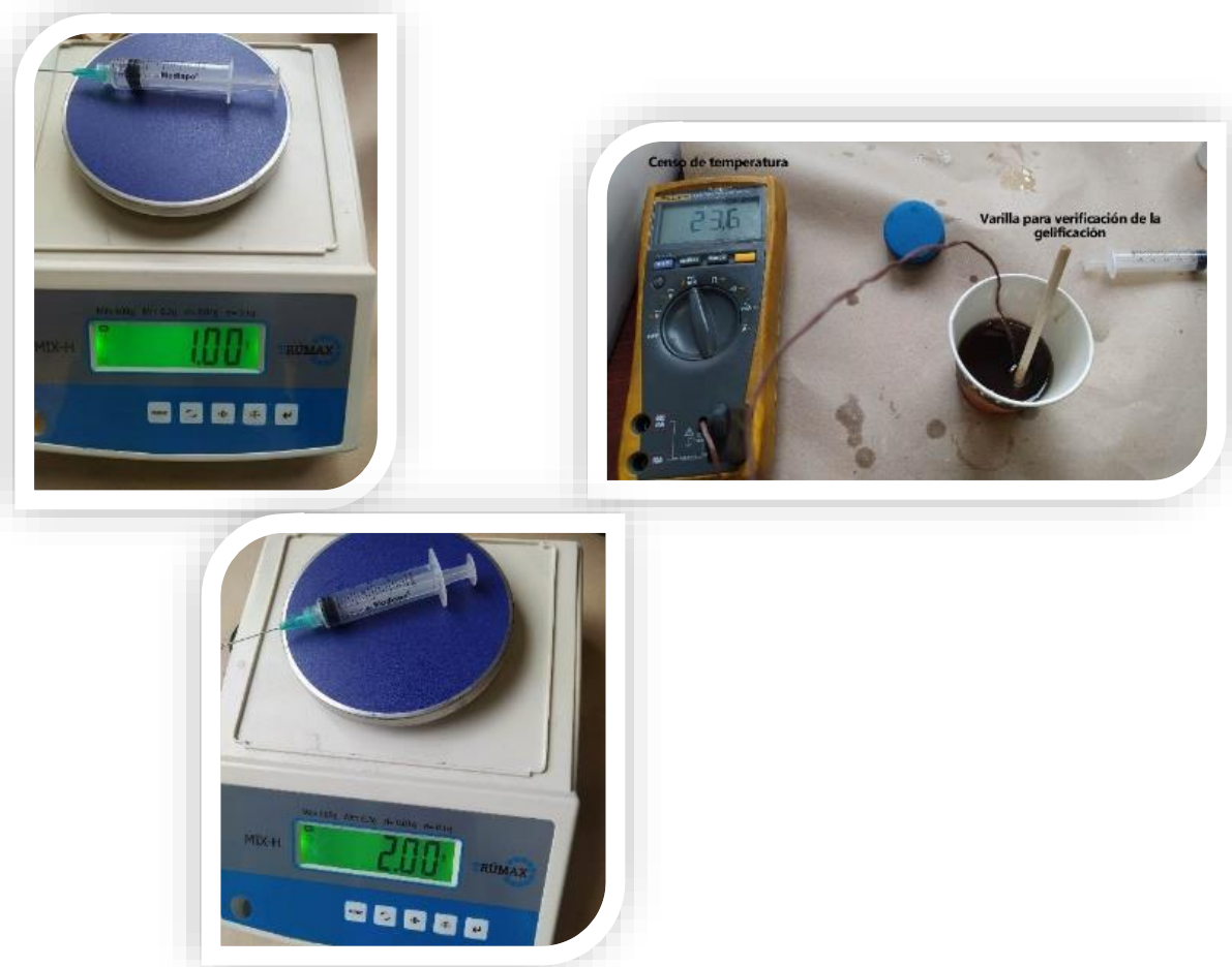
Fig. 4. Esquema de la prueba de tiempo de gelificación realizada.
