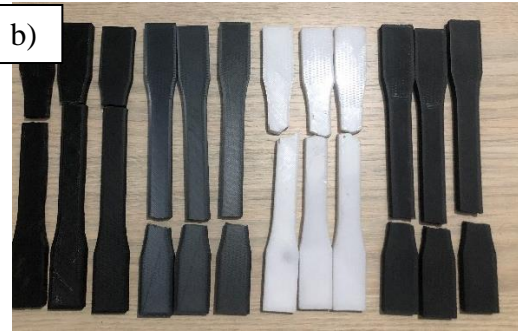
Figura 31. a) velocidades según el tipo de probeta. b) Muestras de tensión fabricadas bajo modelo de impresión 3D PLA, PLA+F.C., PETG y PETG+F.C., según norma ASTM D638 –14. Fuente: Autor
