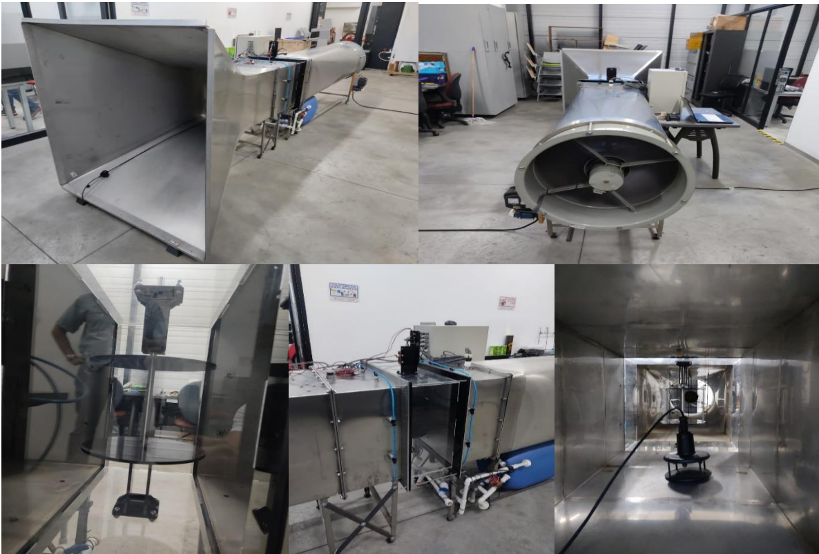
Figura 57. Turbina H-Darrieus en prueba, en túnel de viento Universidad Nacional de Colombia Sede Medellín. Fuente: Autor.
