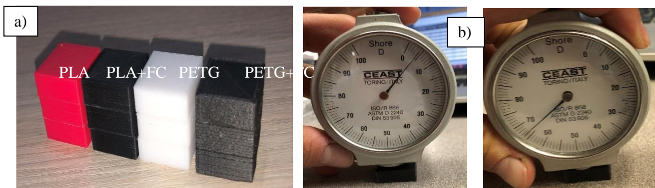
Figura 41 a) Muestras de impacto fabricadas bajo modelo de impresión 3D. b) toma de dureza con medidor shore D Fuente: Autor.
