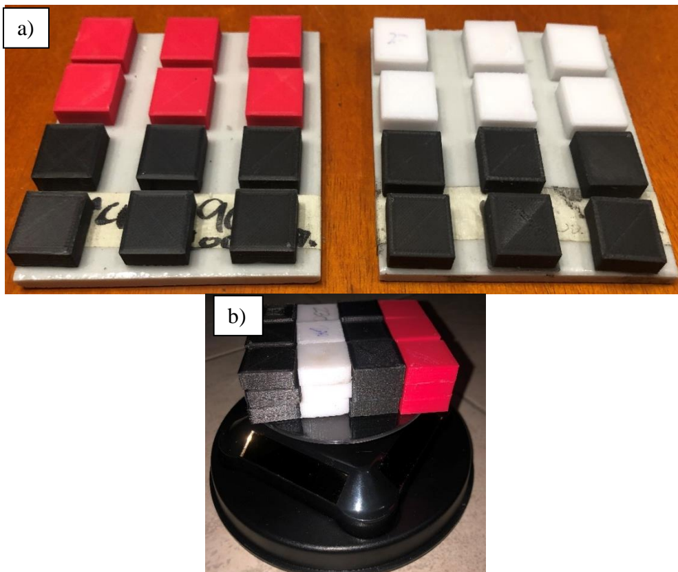
Figura 30. a) Muestras listas para entrar al horno para la exposición térmica durante 8 horas en el orden PLA, PLA+F.C., PETF y PETG+F.C.. b) Muestras organizadas en la base giratoria para prueba de exposición U.V. Fuente: Autor
