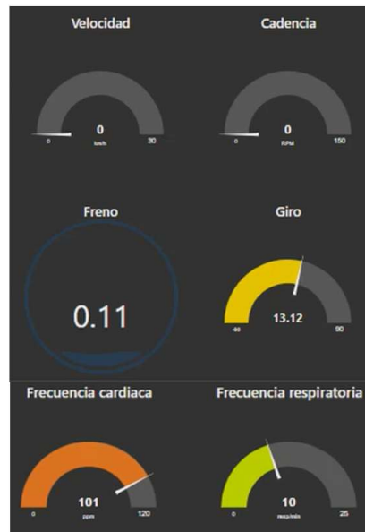
Fig. 14 Visualización de los datos en la interfaz. Cada variable se muestra como un diagrama de aguja y su valor numérico. El freno se muestra con un visualizador de nivel entre 0 y 1.
