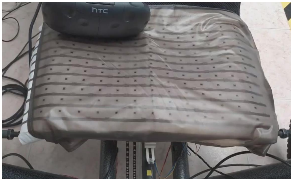
Fig. 33. Malla de sensores de presión en el asiento.
