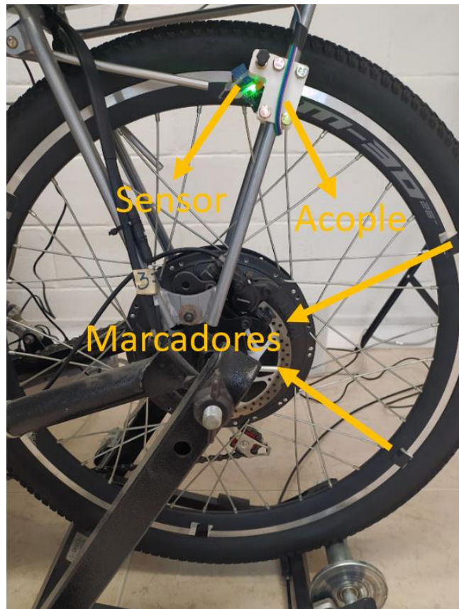
Fig. 20. Fotorreflector en la llanta trasera del triciclo para el cálculo de la velocidad.
