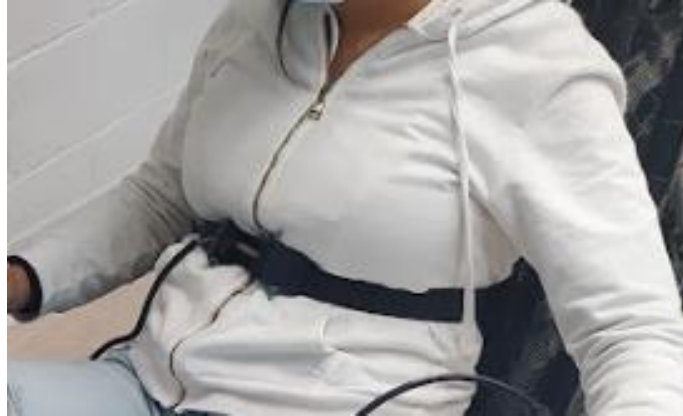
Fig. 28. Sensor del cambio volumétrico del tórax al respirar.
