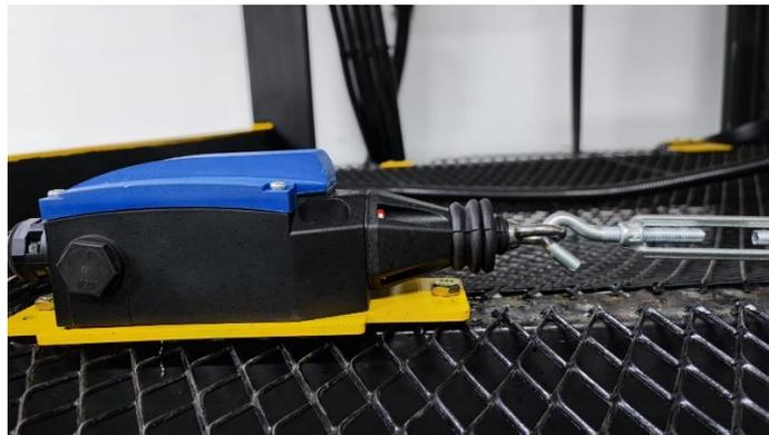
En adición, todos estos dispositivos de seguridad se encuentran conectados a cuatro relés de seguridad, los cuales atacan de manera segura al motor del polipasto en caso de detectar una situación de peligro al momento en que uno de estos dispositivos presente una alarma de falla. Después, para que el elevador pueda desplazarse, los elementos de seguridad deben de estar todos
