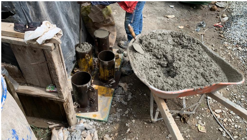
Figura 11 Llenando los cilindros de concreto hecho en obra para ensayos de compresión
