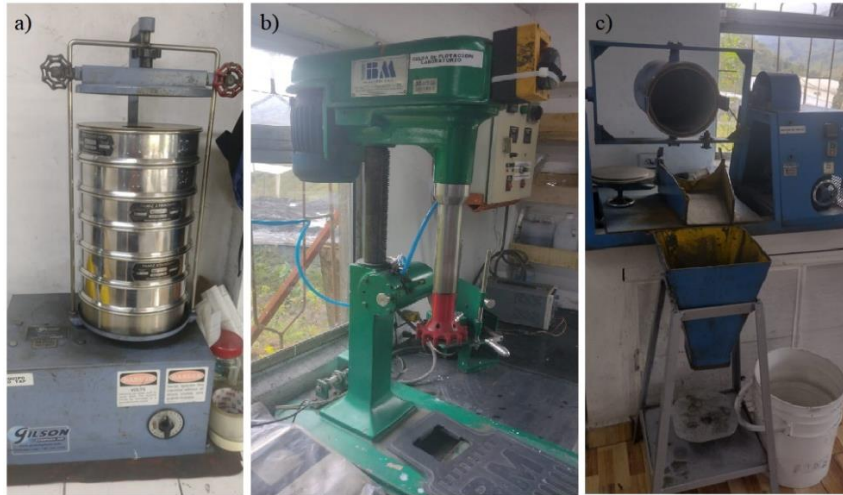
Fig. 9. Equipo de laboratorio. a) Ro-tap. b) Celda de flotación. c) Molino de bolas.
