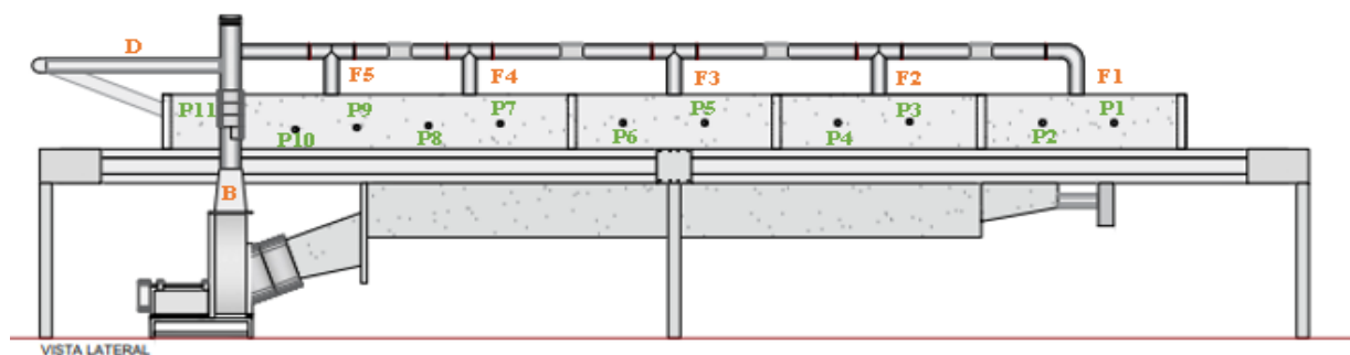
Figura 13. Túnel de remoción de humedad, vista lateral, ubicación de flautas y puntos de toma de muestra de temperatura.
