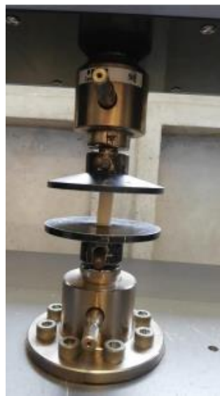
Fig. 13. Montaje para ensayo de compresión.
