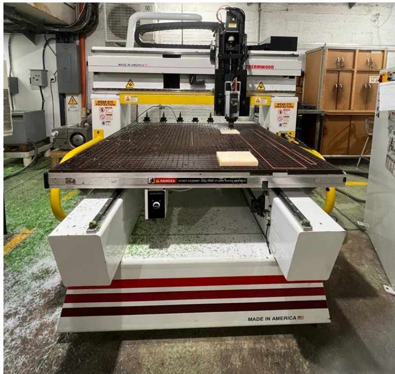
Fig. 6. Máquina control numérico con montaje de placa mediante succión de vacío.
