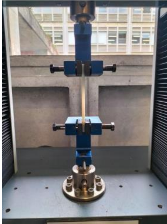
Fig. 12. Montaje realizado para ensayos de tracción.
