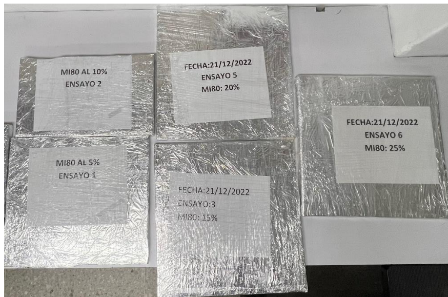
Fig. 5. Láminas terminadas posterior al proceso de polimerización.
