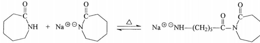
Fig. 3. Reacción de iniciación de la poliamida. [15]
