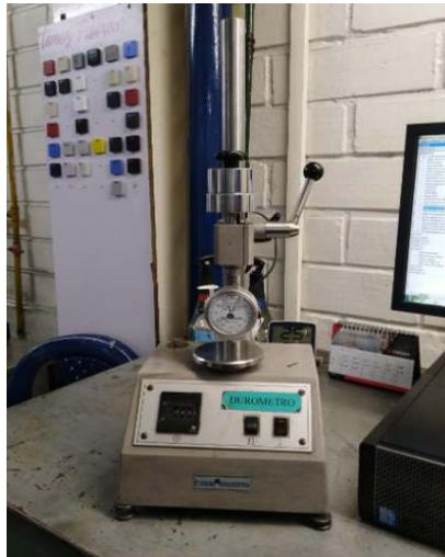
Fig. 13. Durómetro ubicado en el laboratorio de calidad Extrusiones S.A
