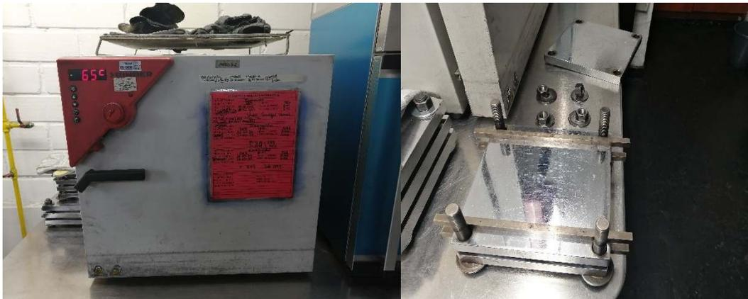
Fig. 12. Horno Binder y molde para realizar la prueba de *compression set*.
