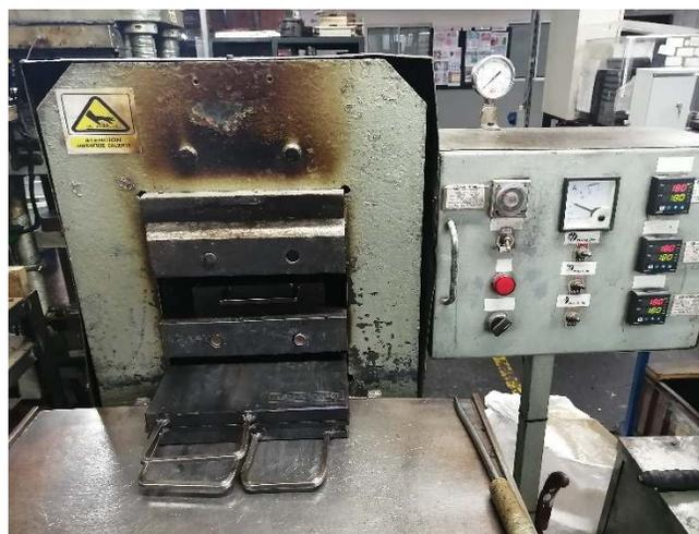
Fig. 14. Prensa de vulcanización compuestos de caucho Extrusiones S.A
