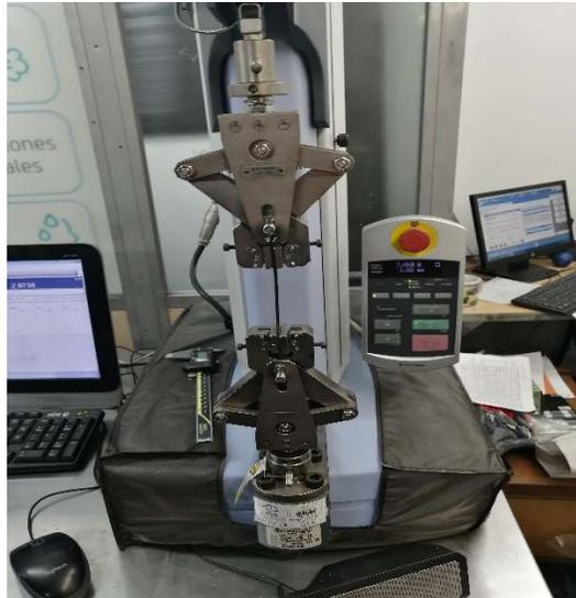
Fig. 9. Máquina Universal EZ Test EZ-LX ubicada en el laboratorio de calidad de Extrusiones S.A
