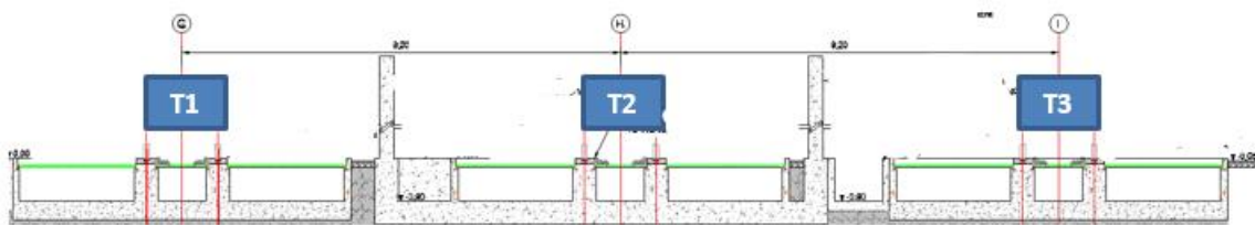
Figura 5. Elevación de fosos de transformador T1 (izquierdo), T2 (centro) y T3 (derecho)
