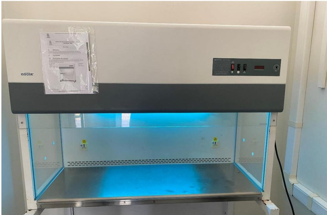
**Fig. 34.** Cabina de flujo laminar usada en el trabajo.
