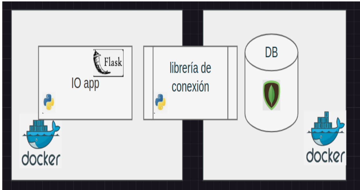
Imagen 10: Arquitectura de la aplicación y conexión con la base de datos mediante la librería diseñada.
