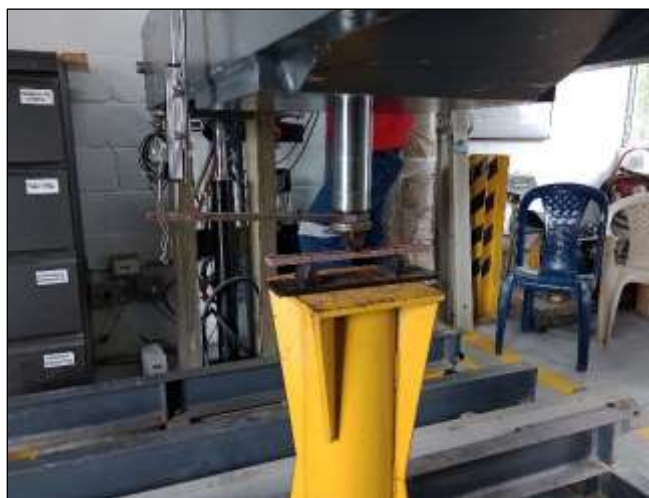
Figura 8. Ensayo preliminar de flexión con celda de carga Dirimpex para las probetas de poliéster fabricadas
