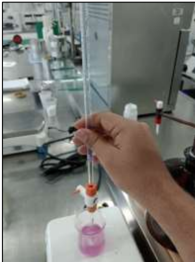
Figura 3. Índice de acidez medido por medio de titulación a la resina de poliéster con y sin residuo de PRFV.
