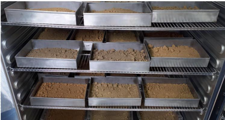
**Figura 2.** Muestras de suelo secando en horno de ventilación forzada
