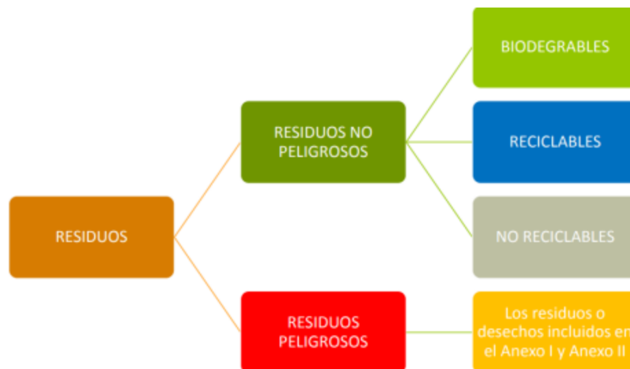
Figura 2. Clasificación de los residuos sólidos de acuerdo con el Decreto 4741 de 2005. (AMVA, 2007).
