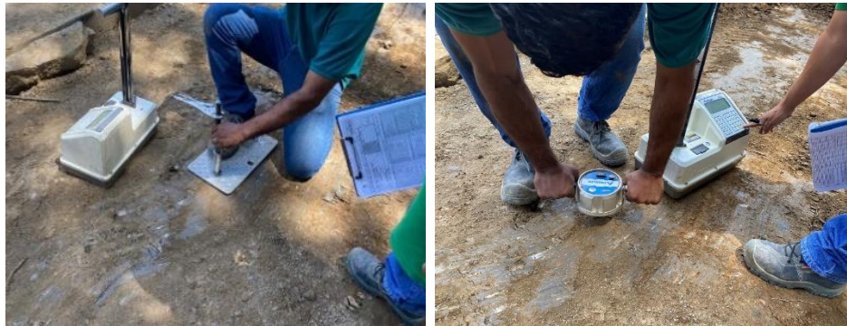
b. Toma de densidades en campo con el método de cono de arena- vereda La Magdalena.
