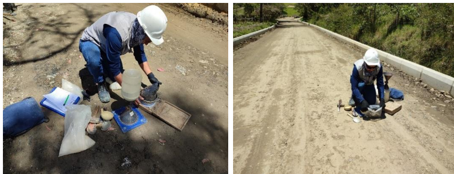
b. Toma de densidades en campo con el método de cono de arena- vereda La Magdalena.
