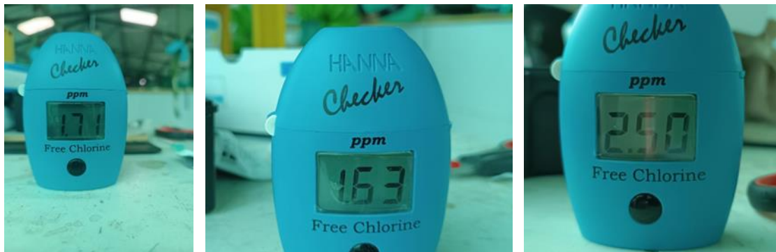
Equipo de medición empleado para el monitoreo del cloro residual
