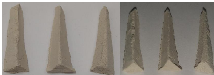
Fig. 10. Conos fabricados para el ensayo equivalente de cono pirométrico (ECP).
