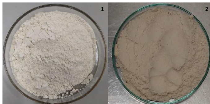
Fig. 5. Materias primas. 1. Arcilla caolín pasante malla 270 (53 µm), 2. Residuo de ladrillo refractario caolín pasante tamiz N° 270 de la serie Tyler (53 µm).
