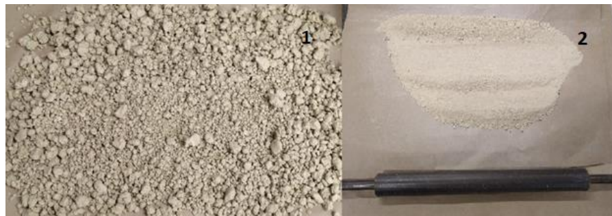
Fig. 4. Materia prima arcilla caolín, 1. Tamaño de partida de la arcilla caolín, 2. Apisonamiento con la ayuda de un rodillo.
