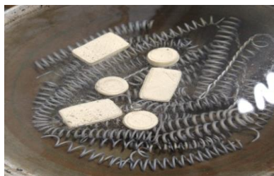
Fig. 11. Ensayo de determinación de la absorción de agua, la porosidad aparente, la densidad relativa aparente y la densidad aparente.
