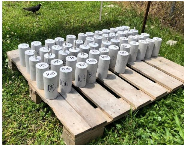
Fig. 15. Exposición sobre bastidor de las probetas de concreto.
