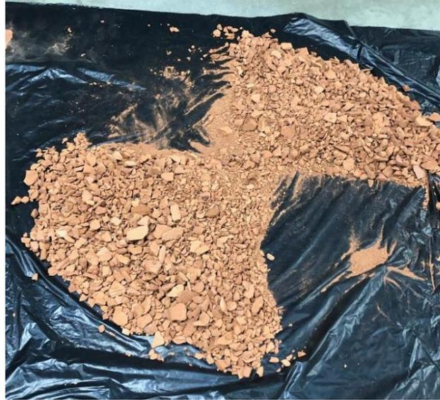
Fig. 14. Agregados gruesos provenientes del reciclaje de ladrillo.
