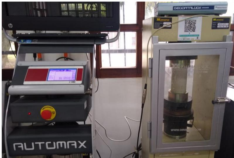
Fig. 4. Equipo para la realización de las pruebas de compresión.
