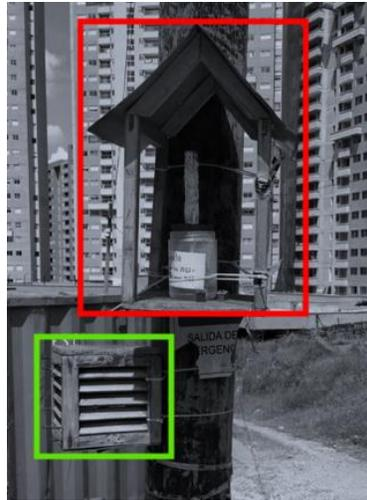
Fig. 5. Disposición de captadores. Captador de cloruros (recuadro rojo) y captador de sulfatos (recuadro verde).
