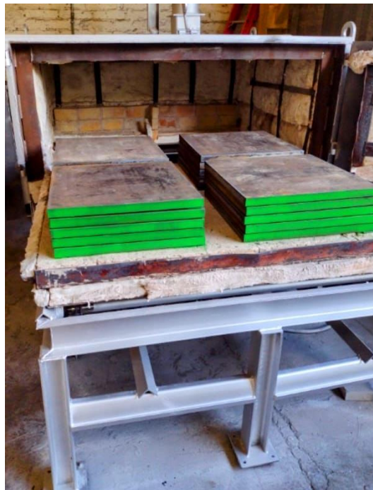
Imagen 44. Tercera carga de recocido, primera carga con parámetros controlados.
