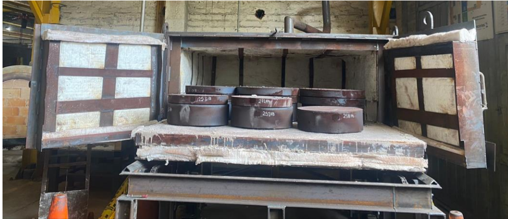
Imagen 20. Carga de recocido después de tratamiento térmico. Segunda toma de dureza.
