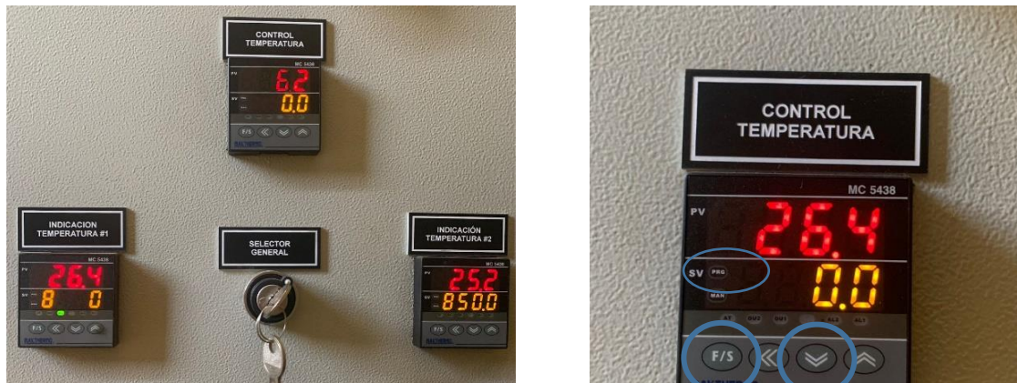
Imagen 27. Reinicio de curva de recocido. a) Control general del tablero en funcionamiento con la curva apagada. b) Verificación de control
