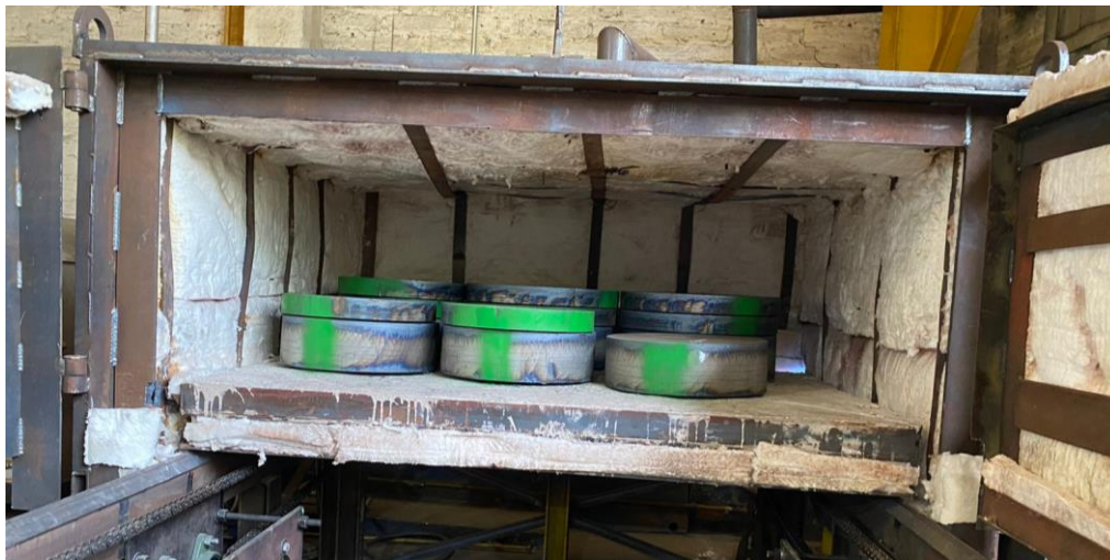
Imagen 19. Carga de recocido antes de encendido del horno. Primera toma de dureza.
