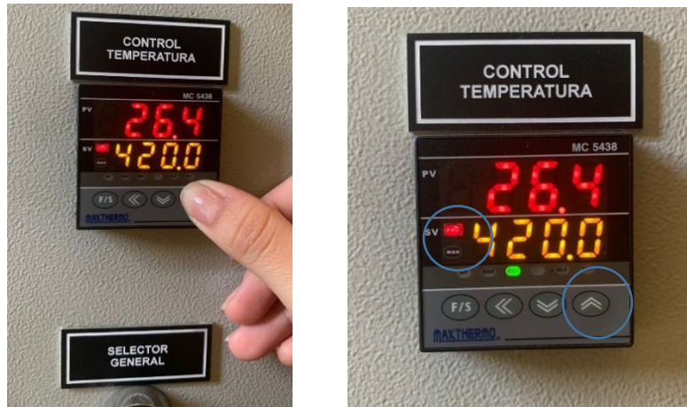
Imagen 23. Tablero de PID. a) Selección para inicio de programación. b) Botón a dejar presionado.
