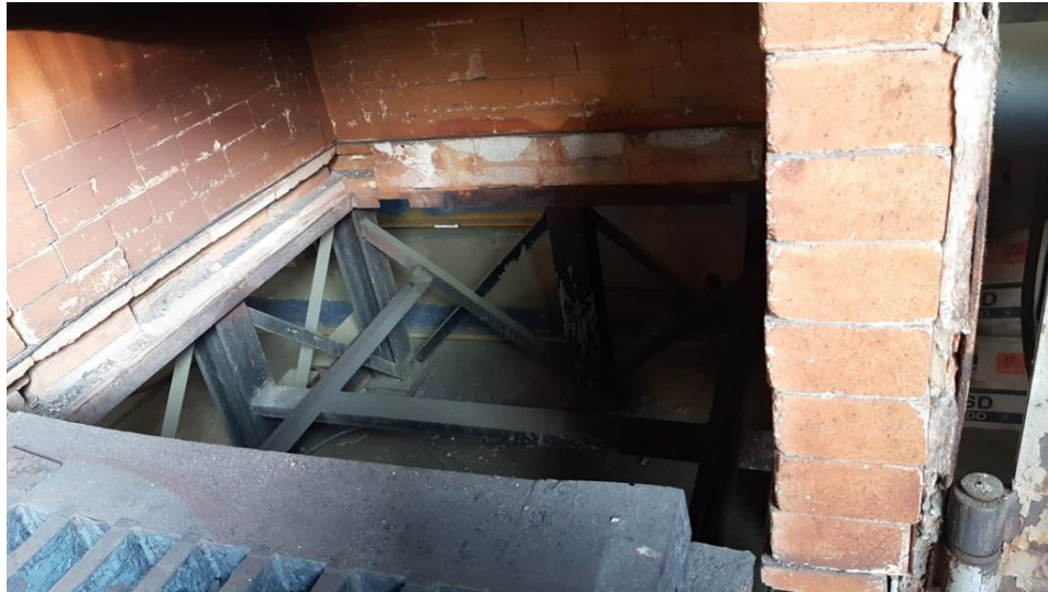
Imagen 38. Sistema de alimentación, rieles dentro del HRI.
