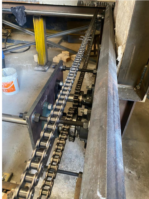
Imagen 41. Sistema de cadenas para alimentación del horno, conexión con motor reutilizado de Ferrocortes
