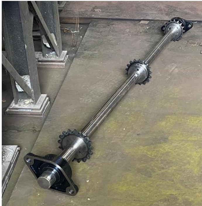
Imagen 40. Sistema de ejes y piñones para HR3.
