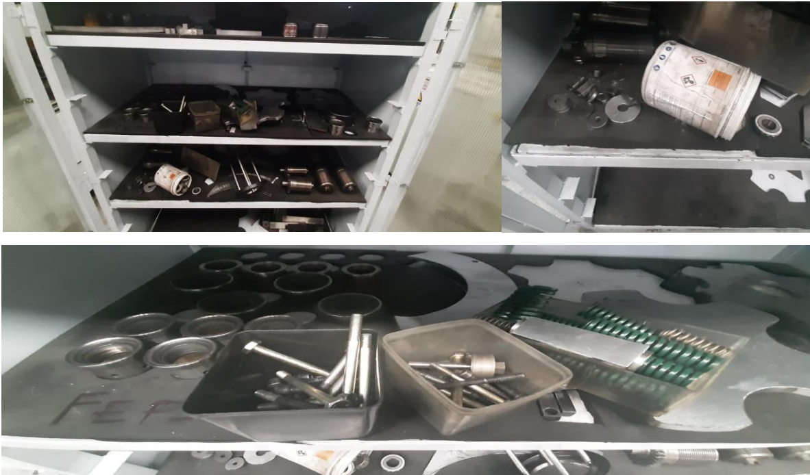
Figura 5. Estado del gabinete de la línea antes de aplicar SMED.
