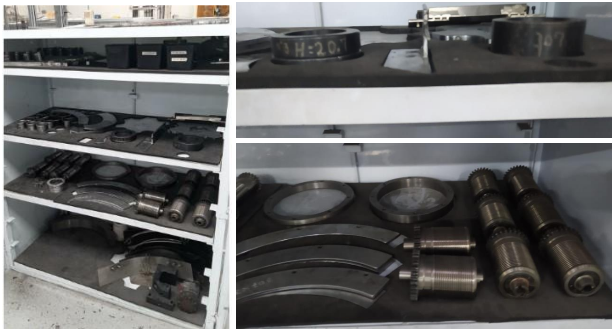
Figura 9. Estado del gabinete de la línea después de aplicar SMED.
