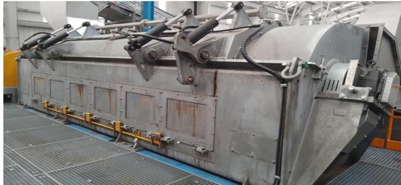
Una vez sale el material de la centrífuga, el *ventilador centrífuga* lo impulsa hacia la línea de clasificación, donde inicia con el *separador balístico* equipo que se encarga de desgarrar y separar las etiquetas, es constituido por 26 ejes rotativos con 52 rodamientos en total, este equipo se apoya de un ventilador y del *transportador de rodillos* para llevar a cabo la separación y el empaque de las etiquetas; las botellas que salen del separador son proveídas a un circuito de 20
