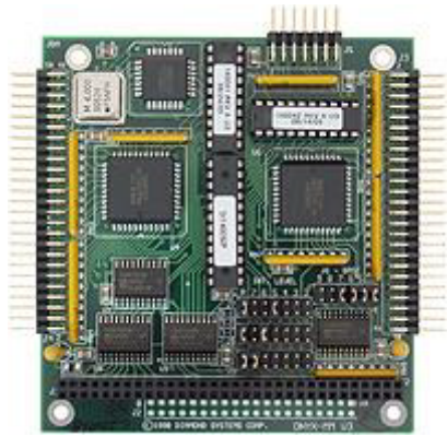
Fig. 20. Onyx MM Digital I/O module.
