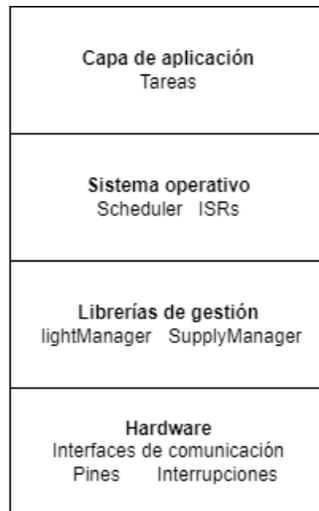
*Figura 10. Capas del firmware.*
