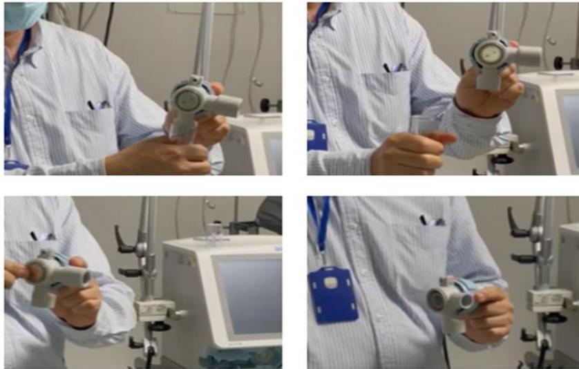
Figura 7. Componentes de la válvula espiratoria Dräger.
