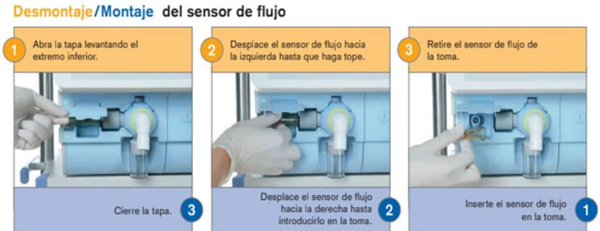
Figura 26. Desmontaje y montaje del sensor de flujo [13].
