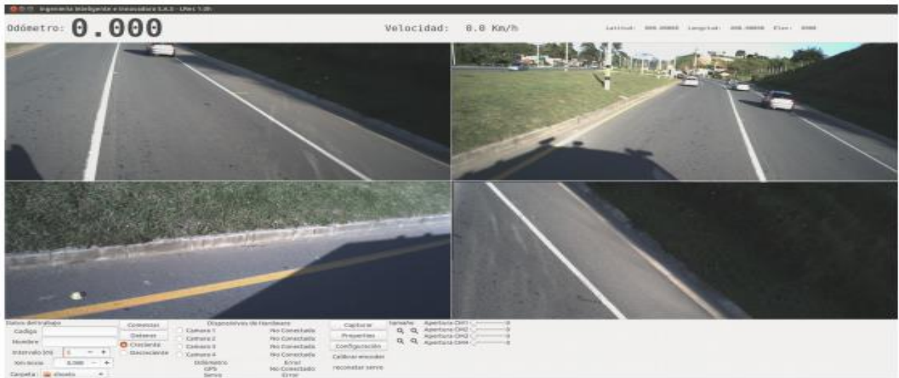
Ilustración 1. Equipo de video para auscultación de Daños y Fisuras.
