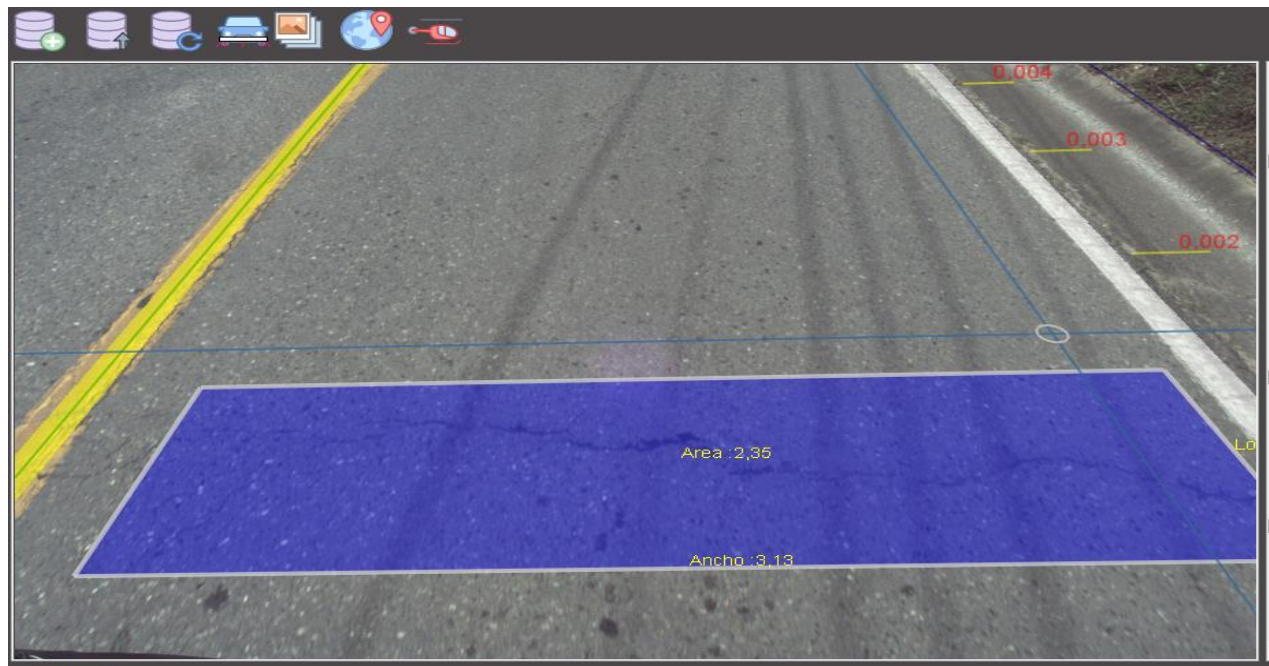
Ilustración 9. Registro de Daños y Fallas
