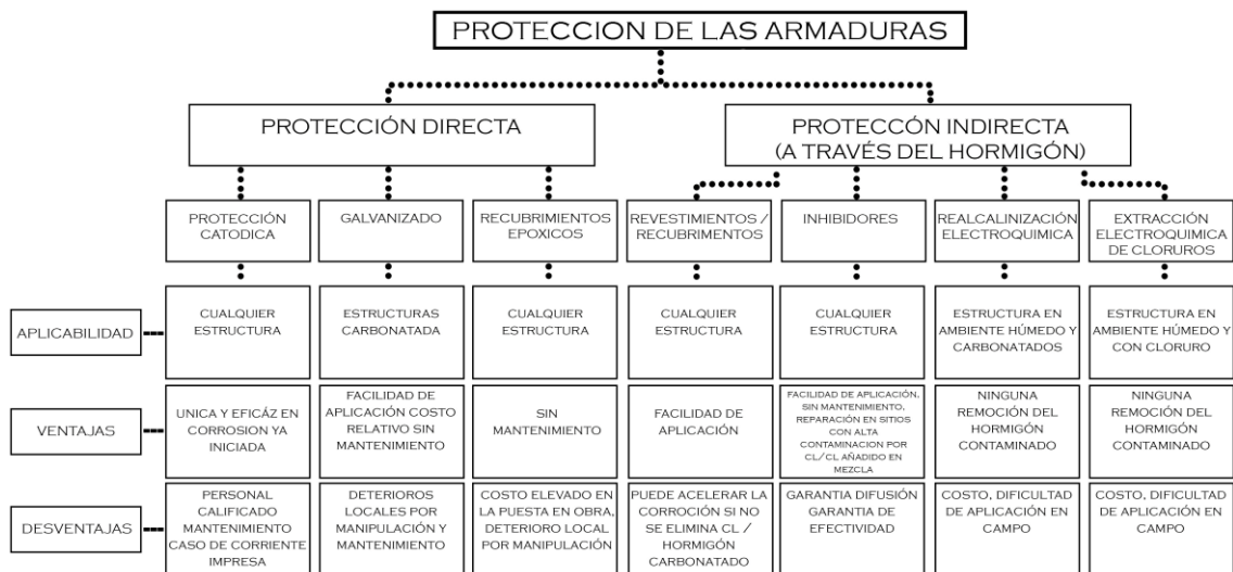
Figura 5 Protección de las armaduras de acero de refuerzo
