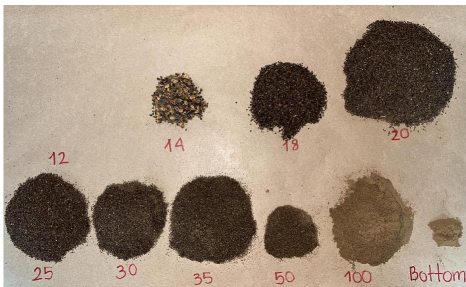
Fig. 4. Distribución de partícula de la torta de higuera por tamaño del tamiz.
