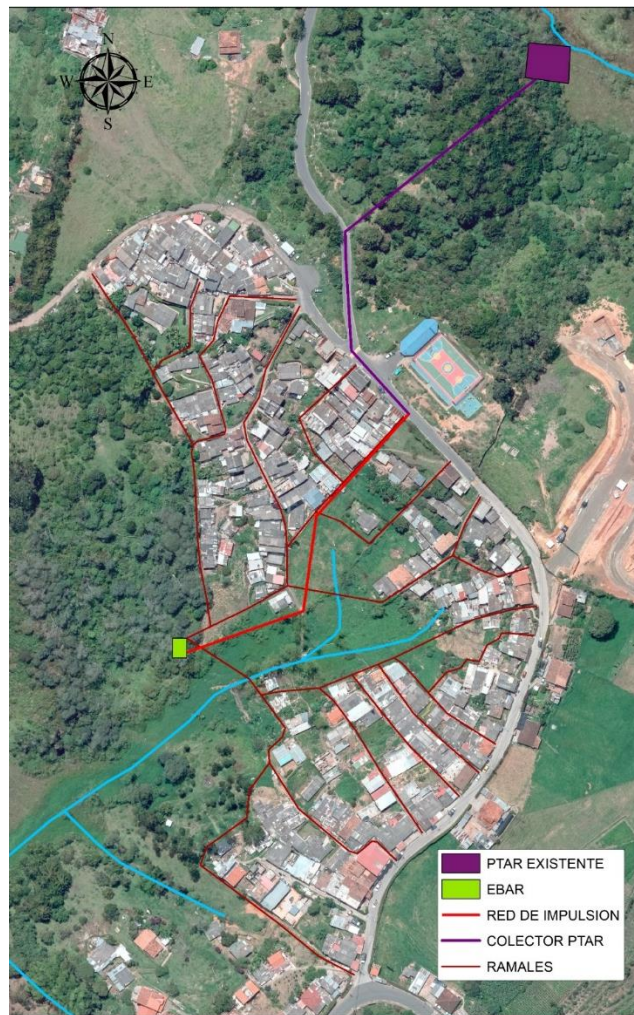
Figura 15 Plano conceptual red de alcantarillado
