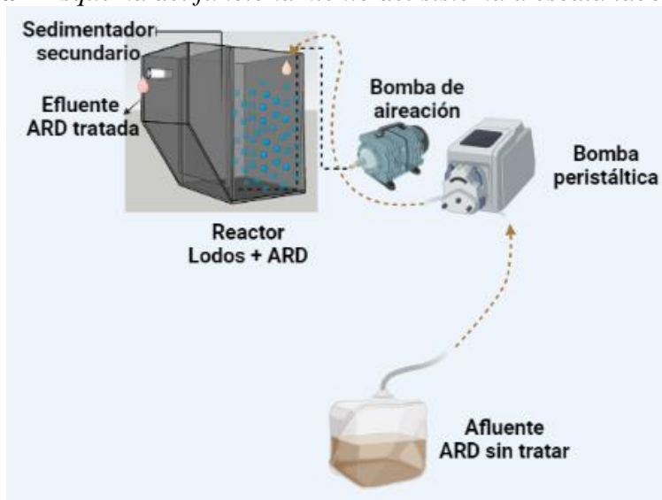
Figura 2 Esquema del funcionamiento del sistema a escala laboratorio
