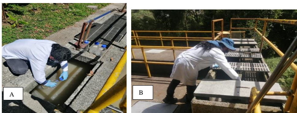
Figura 5 (A) Toma de agua residual en efluente de PTAR (B) Toma de lodo (purga de sedimentadores)
